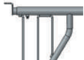
3 Rundrohre Ø 12 mm für Schlupfloch-Sperren
