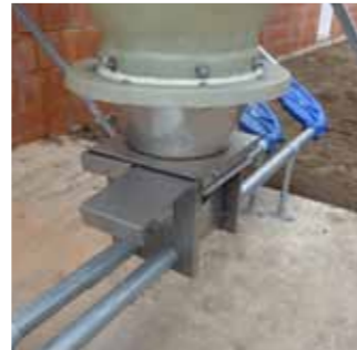
Futteraufnahme station zweifach mit Siloanschlussstrichter
