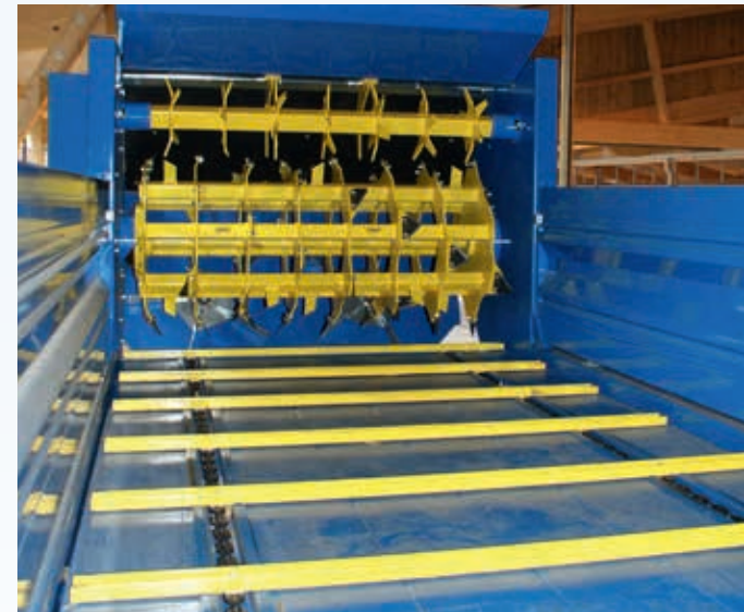
↑ Der Kratzboden steuert automatisch in Abhängigkeit der Belastung der Fräsrolle.
