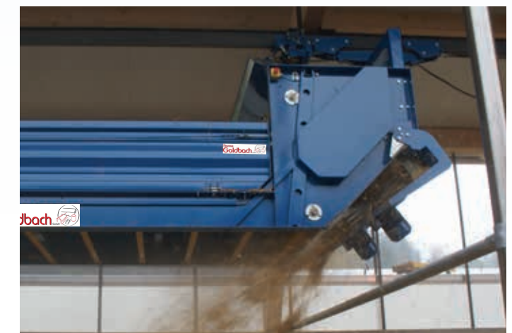
↑ Die Streueinrichtung kann mehrfach verstellt werden – viele verschiedene Streumuster sind möglich.
