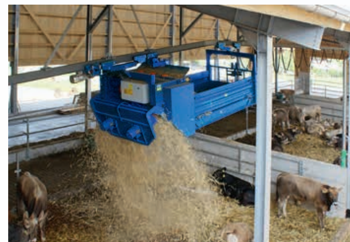
↑ Die Ausbringmenge kann über Funk gesteuert werden.
