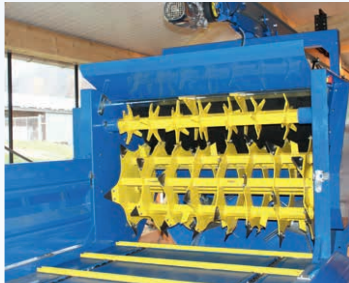
↑ Die Fräsrolle mit bestückten Messern sorgt für ein perfektes Auflöseergebnis.
