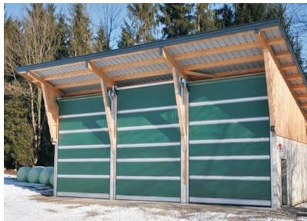
Dieses Tor benötigt zur Seite und nach oben wenig Montageplatz. Es kann platzbedingt innen oder außen montiert werden. Die Alu-Doppel-Kederprofile (ADK) sind in die Plane od. das Netz integriert und verlaufen auf beiden Seiten. Sämtliche Metallteile sind verzinkt. Für den Einsatz im Außenbereich sind zum Schutz optional Seitenverkleidungen und Abdeckbleche erhältlich.
