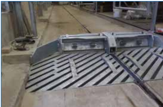
Klapp-Wendeschieber - Umschalten der Klappen nach oben
