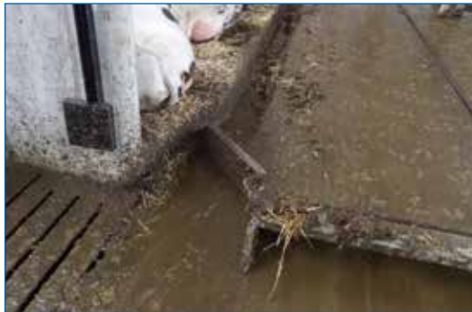
Räumflügel mit einstellbarem Anschlag - Übergang ohne Aufkantung
