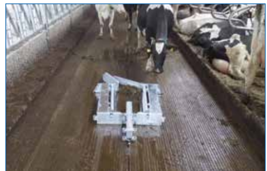
Klappschieber zusammengefallen - überfahrbar
