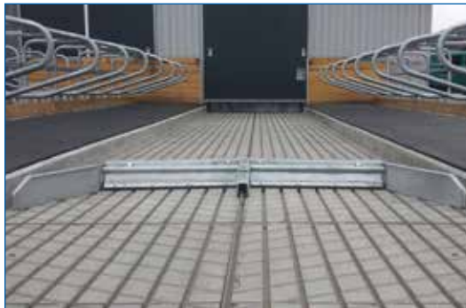
Klappschieber - Ausführung als Kammschieber
