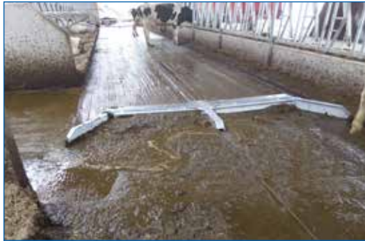
Klappschieber - Übergang ohne Aufkantung
