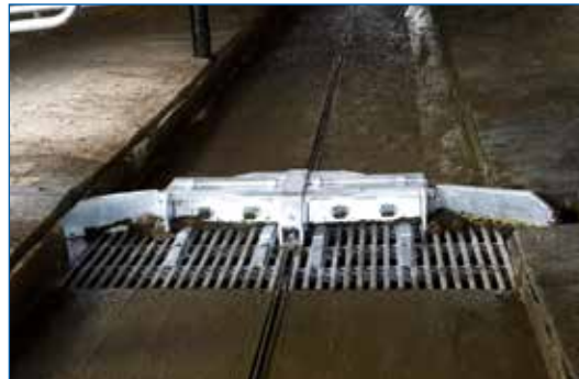
Klapp-Wendeschieber - Umschalten der Klappen nach oben
