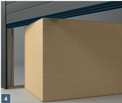
**4 Sicherheitsrandleiste** – die optischen Sensoren der Sicherheitsrandleiste sind in der unteren Dichtung des Tores montiert. Bei Kontakt mit einem Hindernis stoppt das Tor und kehrt in die offene Position zurück - Standard bei automatischen Toren.
