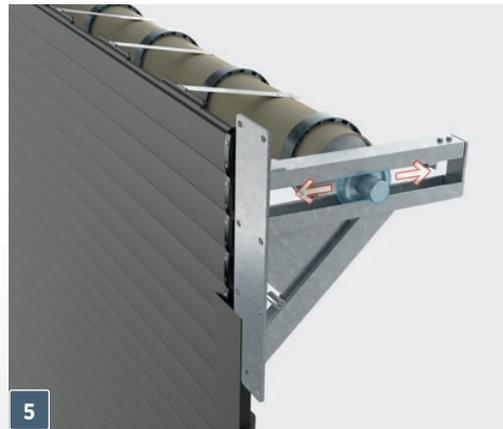
**5 Bewegliche Welle** – Beim Aufwickeln des Vorhangs ändert sie seine Position in Bezug auf die Sturzwand und sorgt so dafür, dass die beweglichen Führungen des Vorhangs in der Achse gehalten werden.
