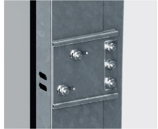
**Geschraubte Verbindung der Zarge mit der Führungsschiene** – wird mittels Montagebleche realisiert. Dank dieser Lösung ist es möglich, die Distanz der vertikalen Führungen einzustellen (Einstellung auf spezielle Bohrungen). Dadurch besteht die Möglichkeit, nur die Führungsschienen auszutauschen. Die Führungsschienen und Zargen werden werkseitig miteinander verschraubt.
