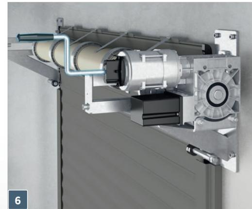
**6 Notfall-Toröffnung** – im Falle eines Stromausfalls kann das Tor manuell mit einer am Antrieb montierten Kurbel oder einem Kettengetriebe zur Notöffnung geöffnet werden.
