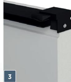
**Eckdichtung** – es ist eine Lösung, die maximale Abdichtung der oberen Ecken des Tores ermöglicht - die Stelle, an der die seitlichen Dichtungen mit der oberen Dichtung verbunden sind.
