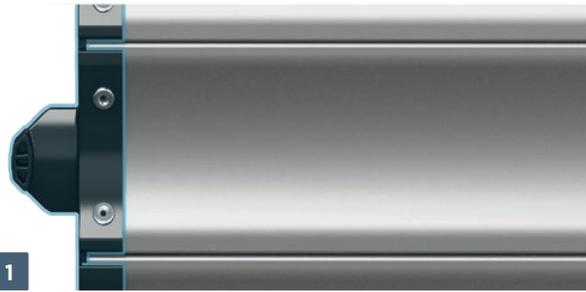
**Windschutzhaken** – werden standardmäßig für Tore mit  $S_o > 5000$  [mm] verwendet. Montiert **auf jedem Torprofil**. Als zusätzliche Option sind auch Haken für Tore mit  $S_o \leq 5000$  [mm] erhältlich. Tore mit Windschutzhaken haben Windwiderstandsklasse 3.
