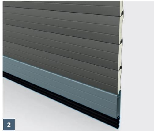
**2 Unteres Profil** – Aluminium-Verstärkungsprofil 115 [mm] hoch, standardmäßig in der Farbe des Torbehangs lackiert.
