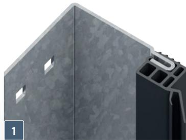
**Seitliche Dichtung** – Eine warme, vierkammerige Hart-Weich-Seitendichtung ist eine moderne und praktische Lösung. Durch die Verwendung einer Doppeldichtung und einer Vier-Kammer-Konstruktion werden einerseits Wärmebrücken am effektivsten eliminiert, andererseits wird ein sicherer Abstand zwischen Sturz und Torblatt geschaffen.
