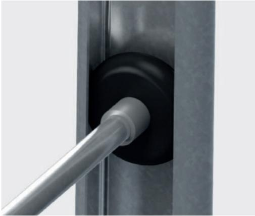
**Führungsschienen** – sind aus 2 [mm] dickem verzinktem Blech hergestellt. Eine dickere Wand in Kombination mit einer richtig profilierten Kante verhindert das Herausfallen der Führungsrollen und trägt wesentlich zur Stabilisierung der Torführung bei.
