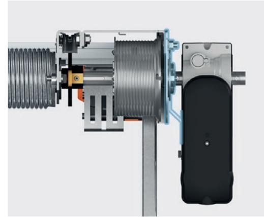
**Befestigung des Antriebs** – Der Antrieb wird an der Torkonstruktion montiert. Die Montage erfolgt mit Hilfe von Montageblechen. Diese Art der Platzierung verkürzt die Montagezeit, überträgt keine Vibrationen auf das Gebäude und ermöglicht es, den Antrieb an Orten zu montieren, die für diesen Zweck nicht geeignet sind (z.B. eine Sandwichplatten).
