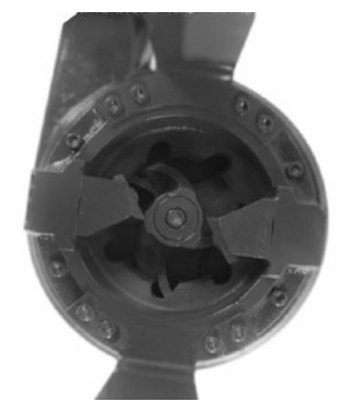
Untenansicht vom Laufrad und einstellbaren Schneidmessern Bottom view of Impeller and cutting blades
