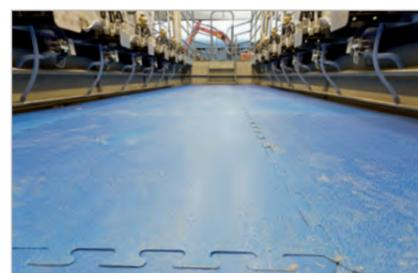
Die **EASYFIX SoftFloor** Matte sorgt für mehr Komfort bei den Melkarbeiten. Da ein Melker viel Zeit im Melkstand verbringt ist nicht nur der Komfort für die Kuh wichtig, sondern auch für den Melker. Sie bietet einen sicheren Stand und wirkt wärmedämmend.
